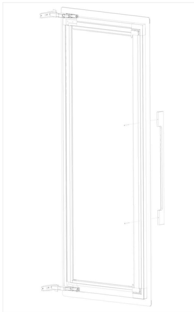
Falls die Schraublöcher im Griff nicht genau zu den Löchern in der Tür passen, müssen Sie mit einer Bohrmaschine die Löcher in der Tür ein wenig vergrößern (auf der Oberflächenseite).
